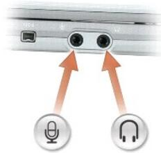
Schließen Sie an den mit dem Symbol
